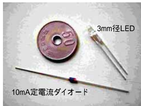
3mm径LEDと 10mA定電流ダイオード
