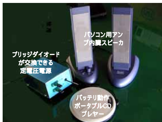
ダイオードの違いによる音の違いの分かる 簡単な試聴装置
