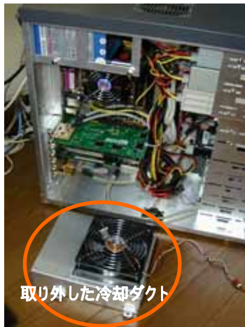
取り外した12cmファンつきCPU冷却用ダクト
