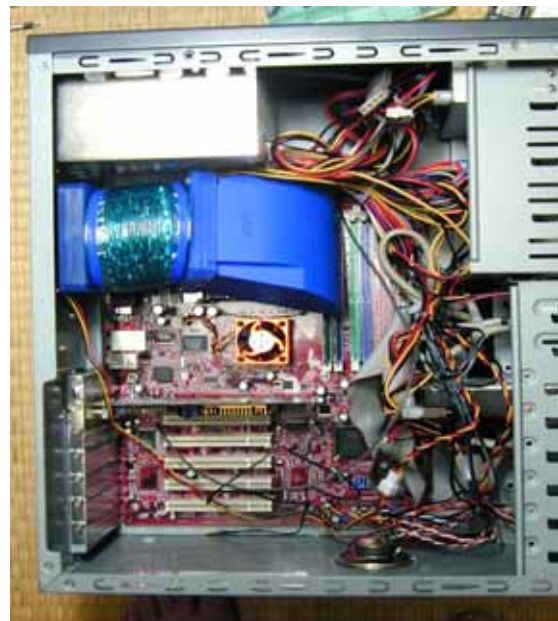
ダクト&フードの組み込み
