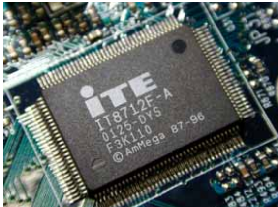
マザーボード上のIT8712F (ハードウェアモニタ、ファンコントロール機能に キーボードやカードリーダーI/Fを統合している)
