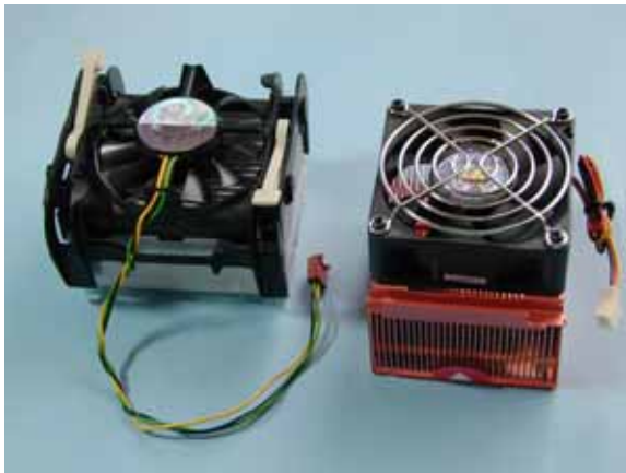
ペンティアム4用CPUクーラー CPU標準添付品(左)とIHC-L71 (いずれも6cmファン使用)
